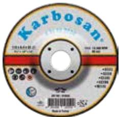
Convient pour le meulage des bavures et des soudures, de tous les aciers de construction, des aciers fortement alliés, des aciers trempés, des aciers tendres, des aciers inoxydables et des fontes d'aciers coulés. Doté de grains abrasifs d'oxyde d'aluminium et d'une structure dure, le produit offre une longue durée de vie et l'avantage d'une coupe rapide.
